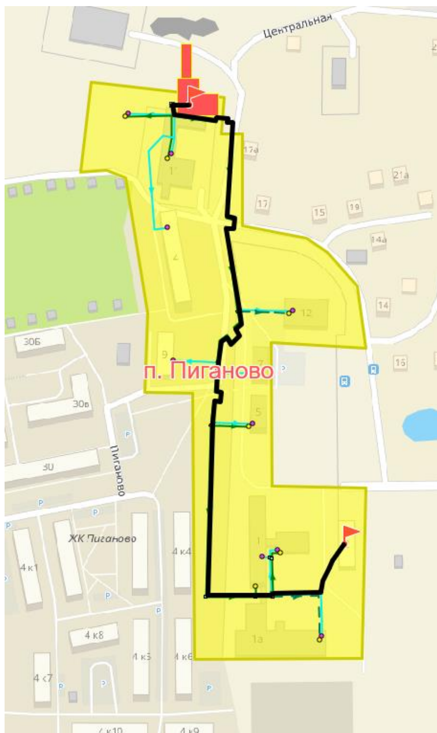
Рисунок 34 – Путь движения теплоносителя от источника тепловой энергии до конечного потребителя
