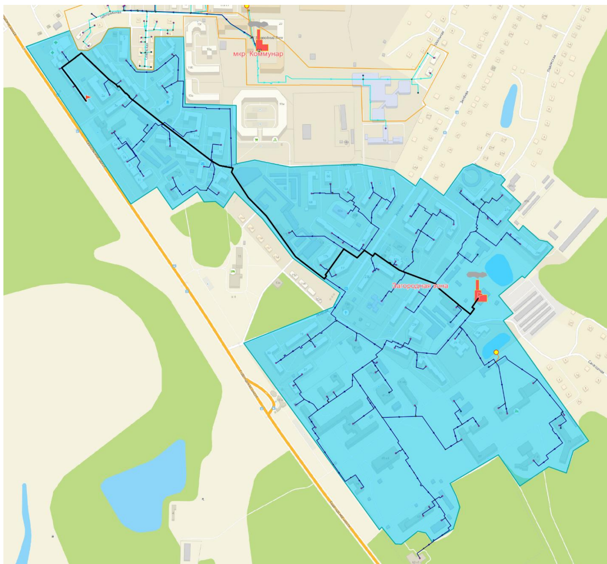
Рисунок 20 – Путь движения теплоносителя от источника тепловой энергии до конечного потребителя
