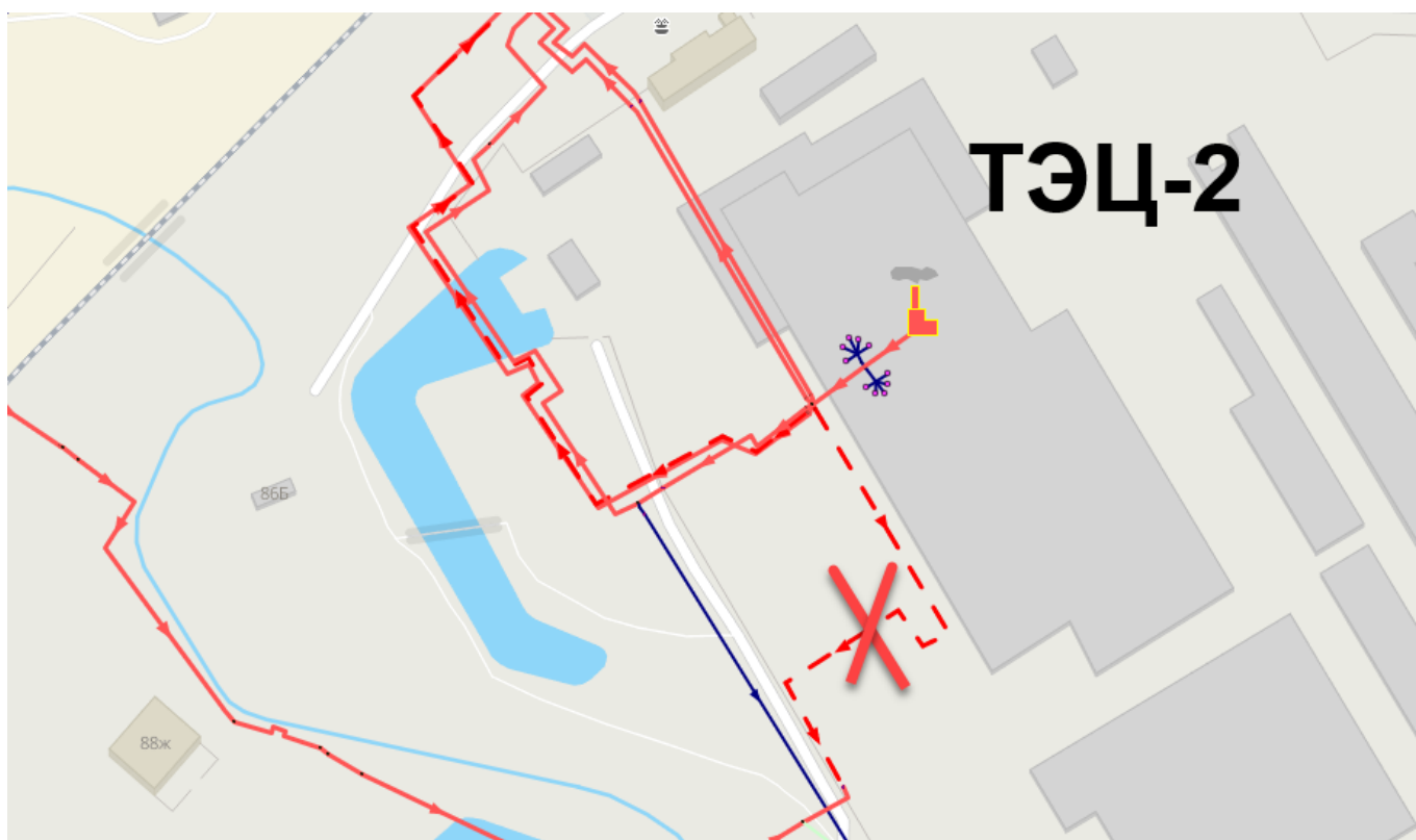
Рисунок 54 – Имитация аварийной ситуации на одном из тепловых выводов ТЭЦ. Отключен подающий трубопровод Ду = 1000 мм, III очередь.
