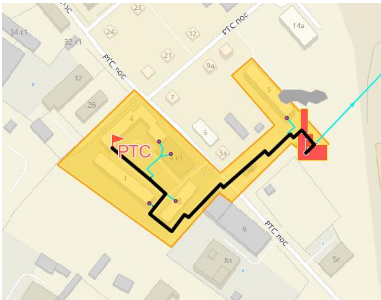
Рисунок 38 – Путь движения теплоносителя от источника тепловой энергии до конечного потребителя
