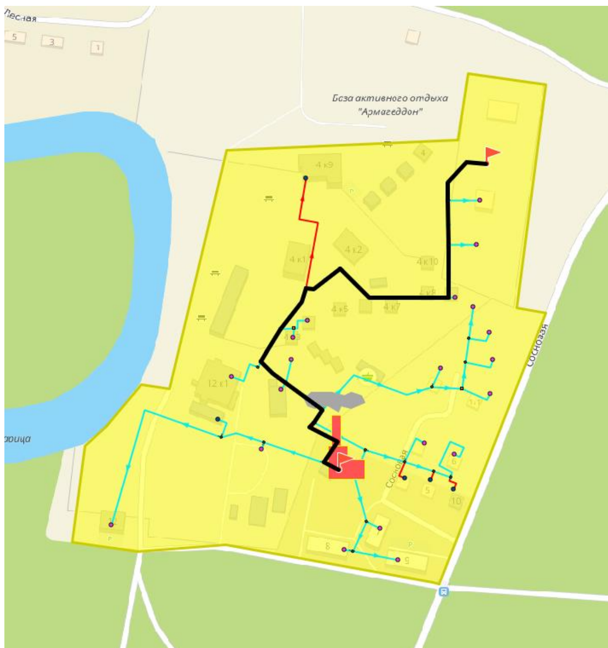
Рисунок 40 – Путь движения теплоносителя от источника тепловой энергии до конечного потребителя
