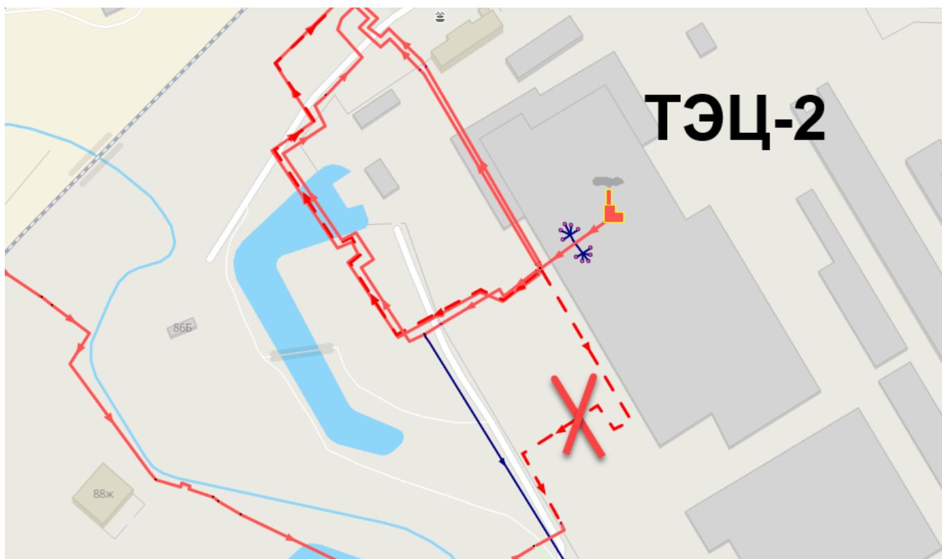
Рисунок 52 – Имитация аварийной ситуации на одном из тепловых выводов ТЭЦ. Отключен подающий трубопровод Ду = 1000 мм, III очередь
